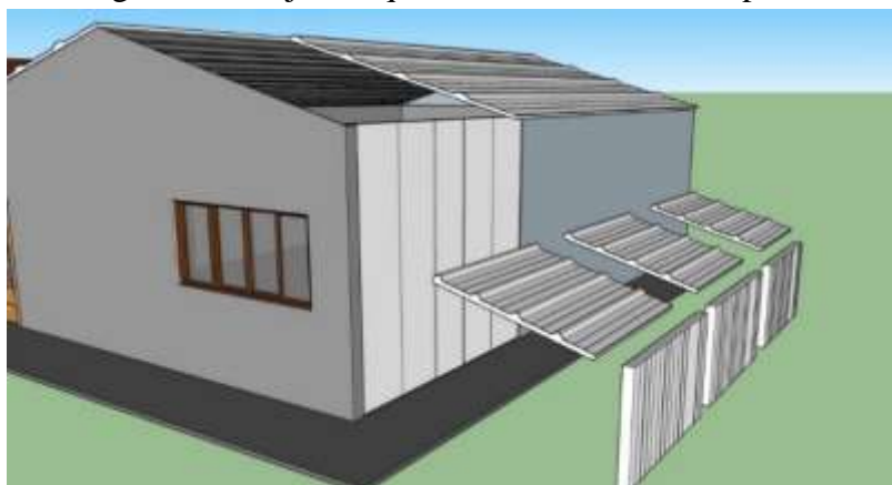
Figura 7 – Projeto arquitetônico de casa de isopainel
