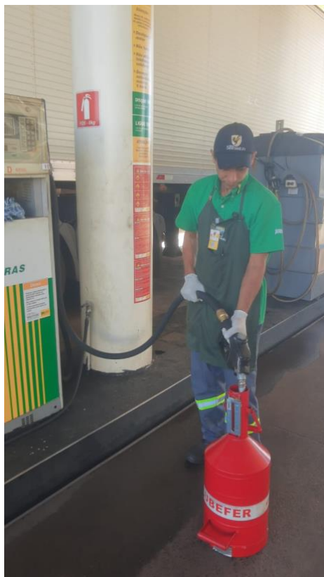
Figura 6 - Aferição de bombas de abastecimentos
