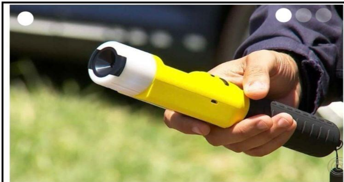
Figura 03 - Tipo de Bafômetro “SELECIONADOR PASSIVO”: Apenas Luzes de Led Verde/Vermelha, não emite som ou imprime relatório. Pré-aparelho para o ALCO SENSOR IV e ou BAF-ELEC-300.
